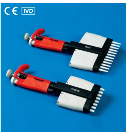
**MICROPIPETAS MULTICANAL DE VOLUMEN VARIABLE – MULTIPET**
